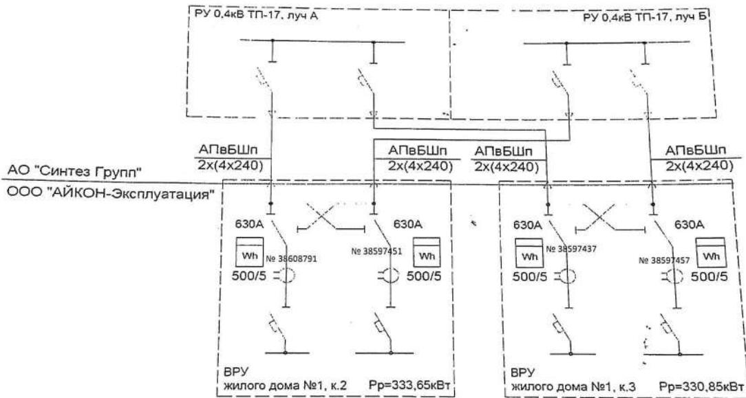
Примечание: в схеме указываются места установки и номера приборов учета, параметры измерительных трансформаторов тока и напряжения, границы балансовой принадлежности (красный цвет) и эксплуатационной ответственности (синий цвет), границы с субабонентами/транзитными потребителями (зеленый цвет), длина и марка питающих кабелей (проводов).
